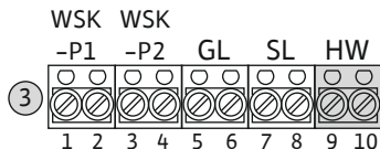
Fig. 13: Клеморед сензори: Аларма за наводнение
