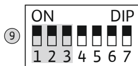
Fig. 19: DIP шалтер 2: Контрол на работните параметри
