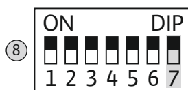
Fig. 16: DIP шалтер 1: вътрешен зумер
