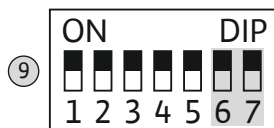
Fig. 10: DIP шалтер 2: Активиране на помпа
