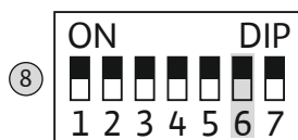
Fig. 17: DIP шалтер 1: Пуск на помпата
