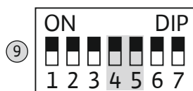
Fig. 18: DIP шалтер 2: Индикация на сервизен интервал
