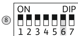
Fig. 17: DIP-вимикач 1: пробний пуск
