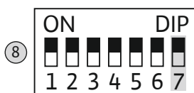
Fig. 16: DIP-вимикач 1: внутрішня звукова сигналізація
