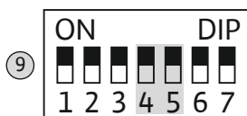
Fig. 18: DIP-вимикач 2: індикація сервісних інтервалів
