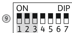
Fig. 19: DIP-прекинувач 2: Надгледување на работните параметри
