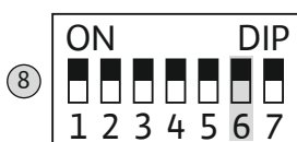
Fig. 17: DIP-прекинувач 1: Ударно стартување на пумпата
