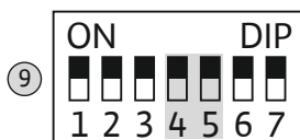
Fig. 18: DIP perjungiklis 2: Techninės priežiūros intervalų rodinys
