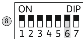
Fig. 17: DIP perjungiklis 1: Trumpalaikis siurblių įsijungimas
