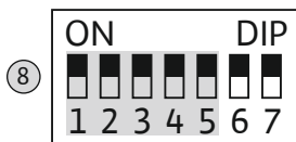
Fig. 9: DIP perjungiklis 1: Variklio elektros srovės kontrolės nustatymas
