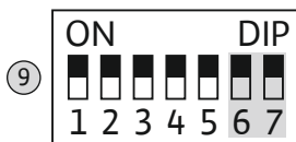
Fig. 10: DIP switch 2: Aktivering af pumper
