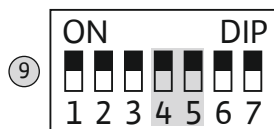
Fig. 18: Микропереключатель 2: индикация интервалов сервисного обслуживания
