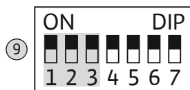
Fig. 19: DIP-переключатель 2: контроль рабочих параметров
