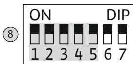
Fig. 9: Микропереключатель 1: настройка контроля подачи питания на электродвигатель
