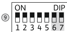
Fig. 10: Микропереключатель 2: активация насосов
