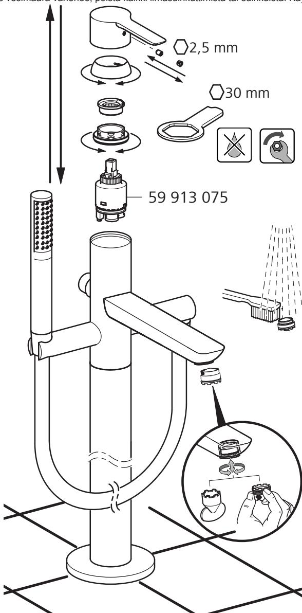
Regolazione dell'arresto acqua calda
