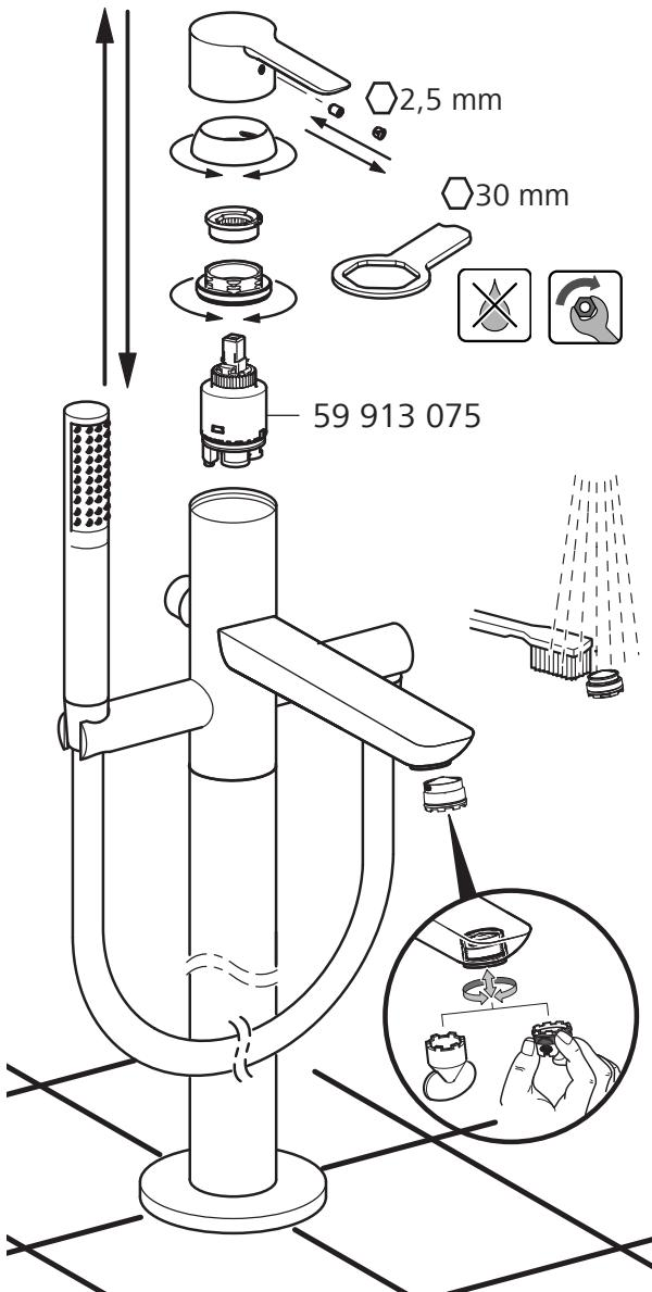
Indstilling af varmtvandsspærring
