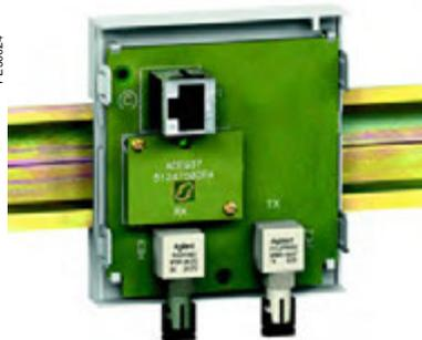
Interface de raccordement réseau fibre optique ACE937.
