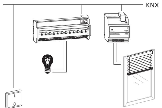
Die Presetfunktion lässt sich beispielsweise dazu nutzen, um über einen Taster gleichzeitig die Beleuchtung zu schalten und die Rollläden zu fahren. Wenn Sie für Preset-Position 1 den Wert 0 % (Rollladen geöffnet) und für Preset-Position 2 den Wert 100 % (Rollladen geschlossen) eingeben, dann können Sie über einen Taster folgendermaßen steuern:
