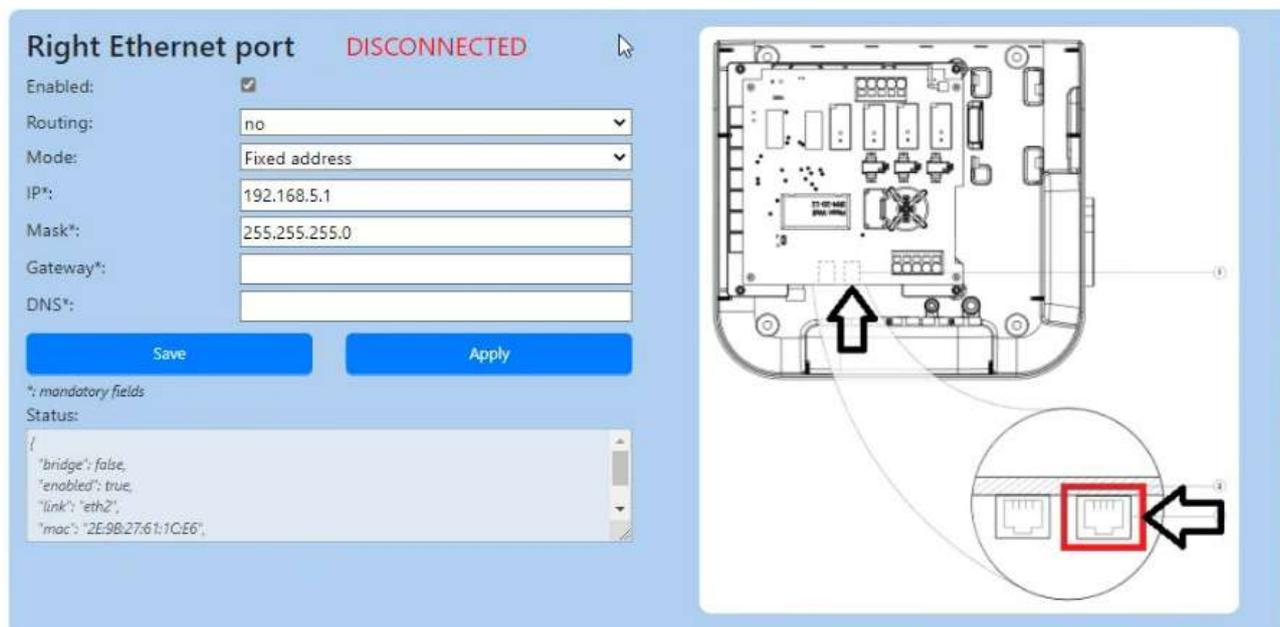
Étapes de la configuration des paramètres de connexion Ethernet (ETH0) :
