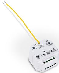
Der Funkempfänger ET-111C ermöglicht einfaches Schalten von elektrischen Heizgeräten sowie Fußbodenheizungen. Der Empfänger kann mit dem ET-14A die Raumtemperatur sowie in Verbindung mit dem Fernfühler ET-EF-111 auch die Fußbodentemperatur steuern. Der Frequenzbereich 868 MHz garantiert eine große Reichweite und optimale Verbindung. Montage in UP-Dose, Schaltstrom: 10 A, Abmessungen: 50x47x33 mm, Schutzart: IP 20, Sendefrequenz: 868 MHz, Reichweite 100 - 300 m, CE konform.
