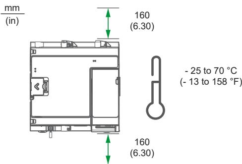
**it** Installare il contatore in un'area in cui viene mantenuta una temperatura ambiente conforme alle relative specifiche. Lasciare spazio al cablaggio e all'accesso.
