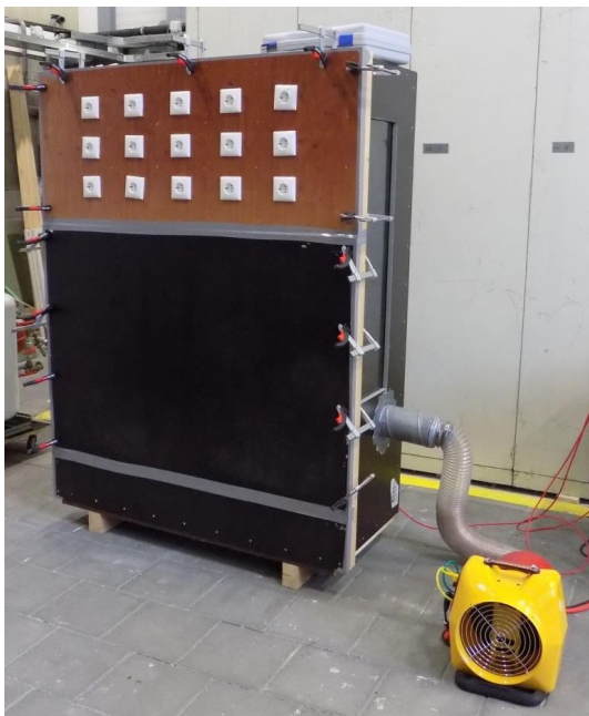
f2.1 Meetopstelling voor luchtdoorlatendheidsmetingen
