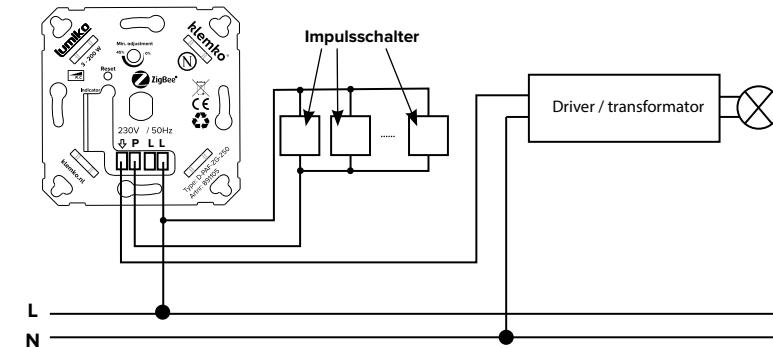
Zwischen Phase L und Anschluss P können mehrere Impulsschalter angeschlossen werden. Dies ermöglicht das Ein- und Ausschalten oder Dimmen der Beleuchtung an mehreren Orten.
