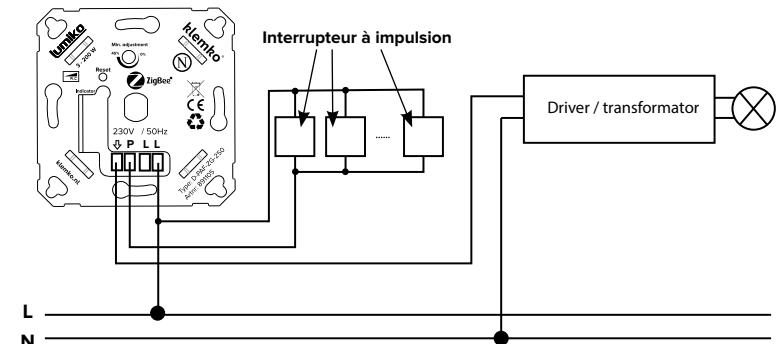
Plusieurs interrupteurs à impulsions peuvent être connectés entre la phase L et la connexion P. Cela permet d'allumer, d'éteindre ou de moduler l'éclairage à plusieurs endroits.
