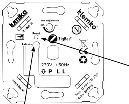
Reset-Schalter zum Verbinden mit dem Netzwerk und Trennen der Verbindung auf Werkseinstellungen.
