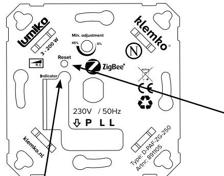
Reset schakelaar voor het koppelen aan het netwerk en ontkoppelen naar fabrieksinstelling.
