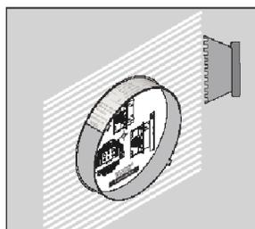
シーリングスリーブを iBox ユニバーサルに取付け、壁面に接着してください。貫通部をより効果的に止水させるために、コーキング処理に加えてこのシーリングスリーブを使用することをおすすめいたします。
