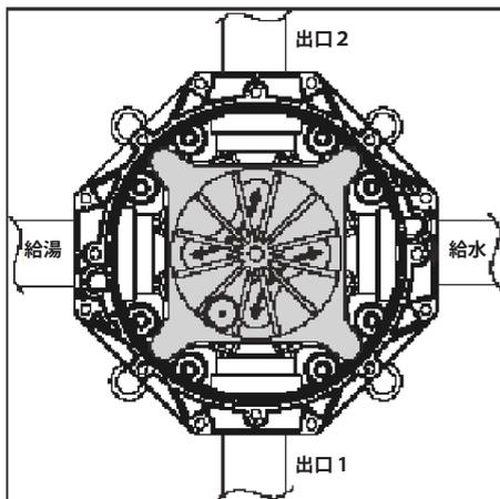
必ず、上下左右及び水平、垂直になるよう取り付けてください。
