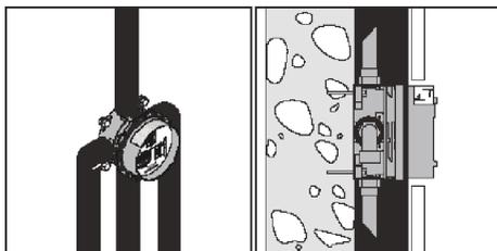
壁仕上面より製品取付面までの取付許容範囲：80-108mm
