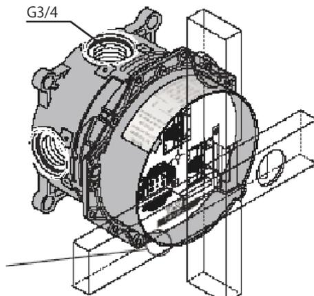
オーバーヘッドシャワー、ボディシャワー、またはハンドシャワー等、多数のシャワーを組み合わせて使用する場合は、給水と給湯は同水圧、流動圧で最低 0.2MPa 必要となります。
