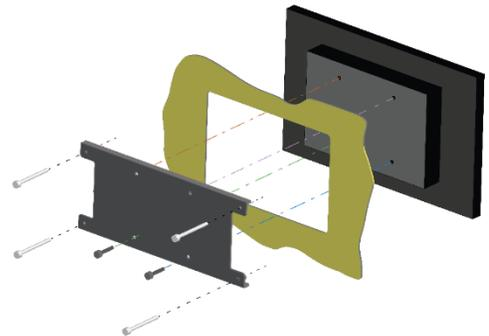
Placer la plaque arrière contre la partie arrière de l'unité eXplore et ré-insérer les 4 vis VESA 75.
