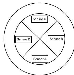
Quatre capteurs à infrarouge passifs indépendants (secteurs A à D) se mettent en mode enregistrement déplacement. Via l'application ETS, il est possible de paramétriser les quatre capteurs en même temps ou chaque secteur séparément. Dans l'onglet « Capteurs de déplacement », vous pouvez choisir entre les réglages « Libéré » et « Verrouillé ». Lorsque les réglages des secteurs orientés sont verrouillés, la sensibilité et la portée des quatre capteurs sont définies sur le même degré.
