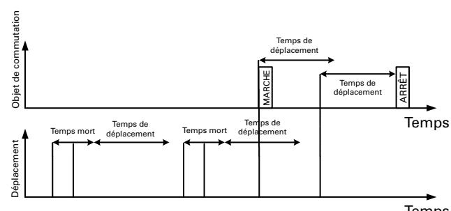
En mode maître ou en mode normal, la durée de déplacement correspond à la minuterie d'escalier présentée dans le diagramme ci-dessus. En mode esclave ou en mode de surveillance, la durée de déplacement correspond au temps de cycle. Dans la pratique, il est possible de mettre en œuvre un grand
