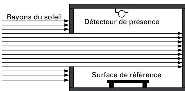
Conditions d'éclairage optimales pour la correction de la valeur réelle. La lumière naturelle impacte de la même manière les résultats des mesures, qu'elles soient effectuées sur le lieu de montage ou dans la zone de référence.
