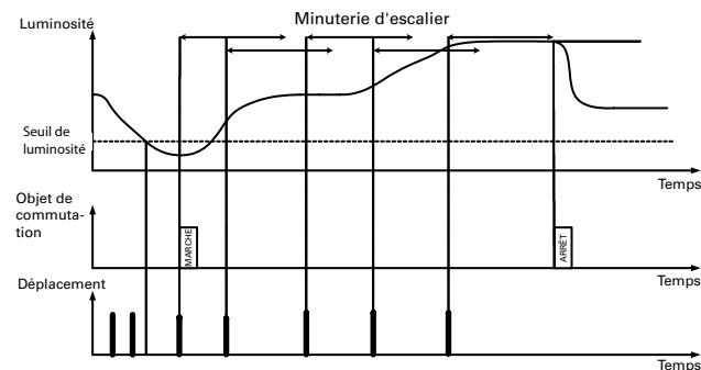
Différence par rapport au détecteur de présence : le détecteur de mouvements passe dans le mode indépendant de la luminosité une fois que l'action de déplacement (envoi d'un télégramme ON) a débuté. Dans ce cas, les déplacements détectés récemment peuvent déclencher à nouveau la minuterie d'escalier. Contrairement au détecteur de présence, le détecteur de mouvements ne peut pas traiter la valeur de démarrage de luminosité et il n'existe même pas de réglage d'hystérésis.
