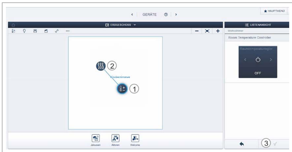
Abb. 13: Aktor und Sensor verknüpfen
