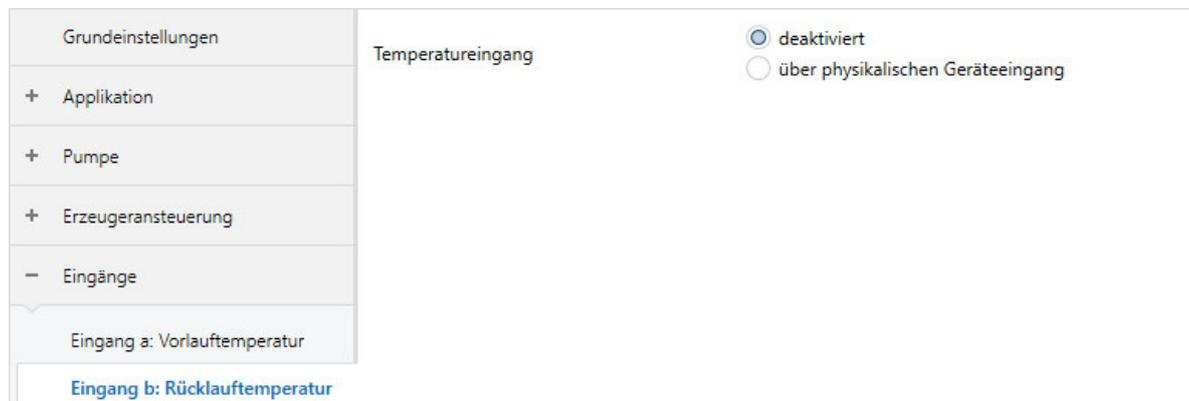
Abb. 12: Parameterfenster Eingang x: Rücklauftemperatur
