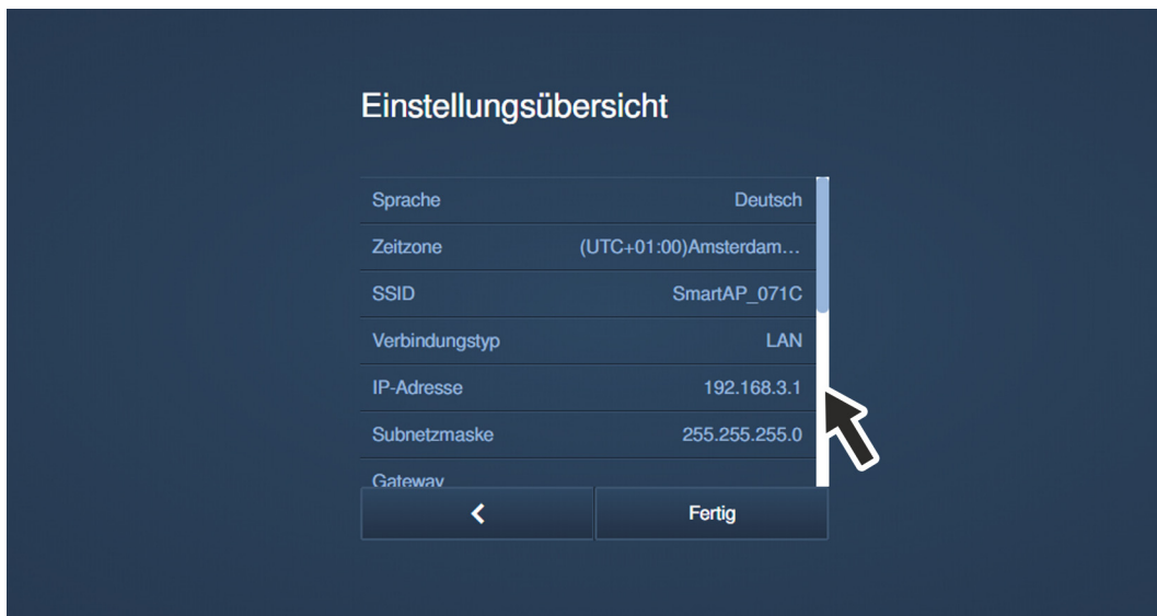
Рис. 36: Ввод «Smart Access Point» в эксплуатацию: обзор настроек
