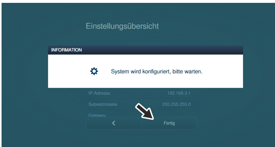
Рис. 37: Ввод «Smart Access Point» в эксплуатацию: подтверждение настроек
