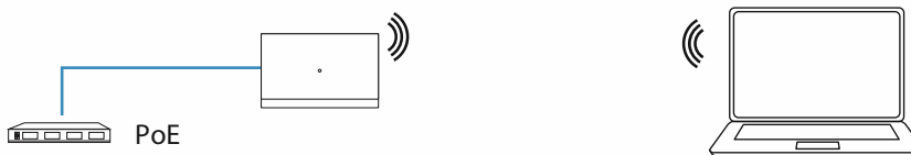
Рис. 19: Подключение «Smart Access Point» к ПК (режим точки доступа)
