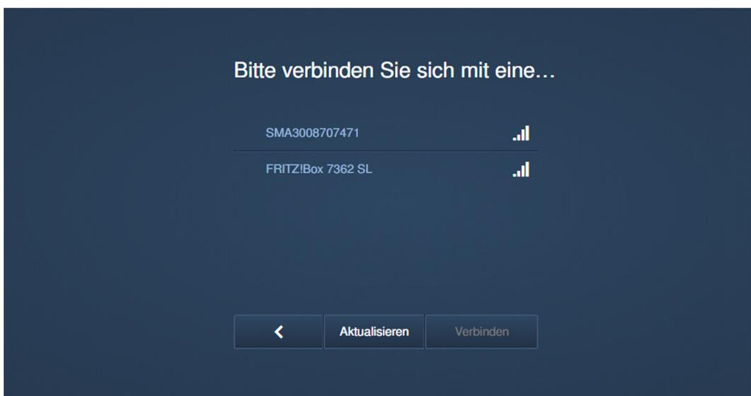
Fig. 30: Messa in funzione "Smart Access Point": collegamento WLAN
