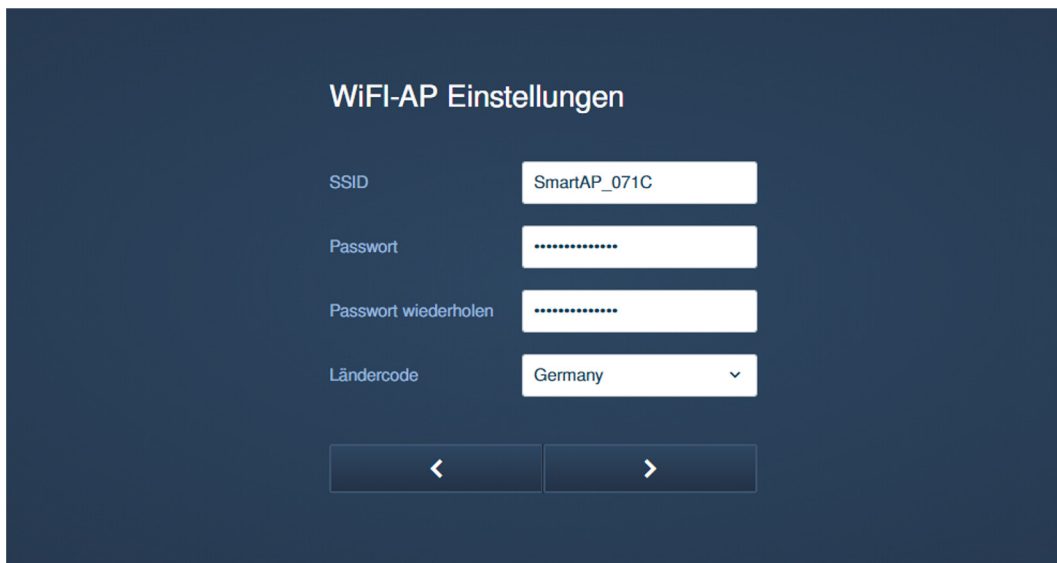
Fig. 27: Puesta en servicio del "Smart Access Point": ajustes WiFi
