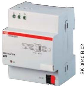
Die EIB / KNX-Spannungsversorgung erzeugt und überwacht die EIB / KNX-Systemspannung. Mit der integrierten Drossel wird die Buslinie von der Spannungsversorgung entkoppelt.
