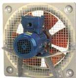
Ventiladores helicoidales murales, especialmente diseñados para la extracción de aire en atmósferas explosivas, con embocadura en chapa de acero galvanizado, anillo interior en aluminio, soporte motor y hélice en aluminio, acabado con pintura gris aluminio B-0920, motor trifásico (HDT), IP55, Clase F, con rodamientos a bolas de engrase permanente. Tensión de alimentación. Trifásicos 230/400V-50Hz.
