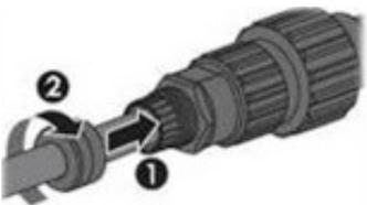
5. Montieren Sie das Steckergehäuse und den Adapter wie unten gezeigt. Drücken Sie den Adapter und die Schale mit der Hand zusammen, bis ein Klicken zu hören oder zu spüren ist.
