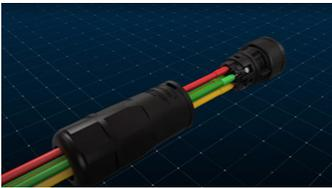
3. Stecken Sie die gecrimpten Leiter L1, L2, L3, N und PE in die entsprechenden Klemmen und ziehen Sie die Schraube mit einem Sechskant-Schraubendreher (Größe: 2,5, 1,2~2,0 N.M ) fest. Vergewissern Sie sich, dass alle Leiter fest in den Schraubklemmen des Buchseneinsatzes sitzen.
