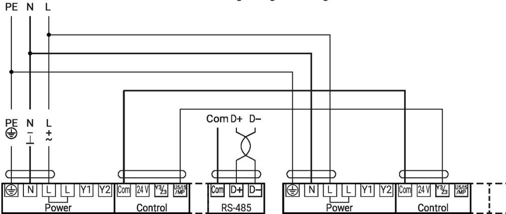
Anschluss aktive Sensoren (BACnet MS/TP / Modbus RTU / MP-Bus)
