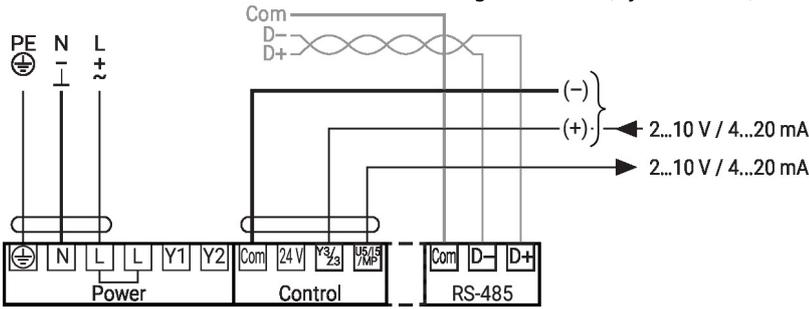
Anschluss BACnet MS/TP / Modbus RTU mit analoger Folgeschaltung
