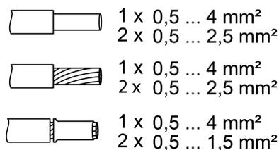
Bild 2: Klemmbarer Leitungsquerschnitt
