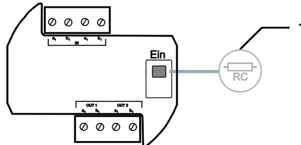
Abb. 2: Abschlusswiderstand am Gerät setzen
