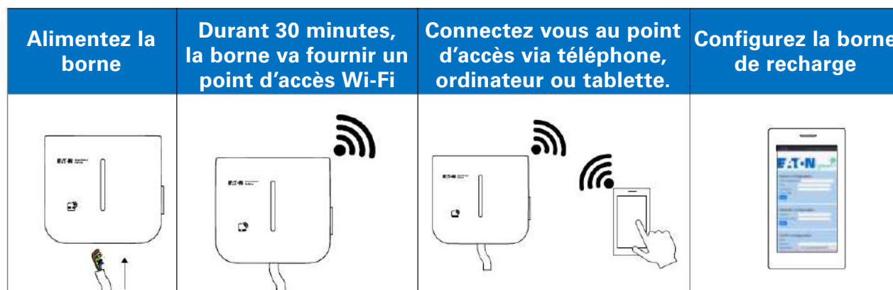
Figure 27. Connexion de la borne de recharge via point d'accès Wi-Fi
