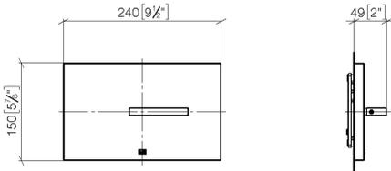
Abdeckplatte für WC-UP-Spülkasten der Firma TeCe - Messing gebürstet (23kt Gold)
