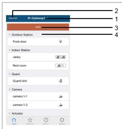
Depois de emparelhar a aplicação móvel com o Gateway IP, a aplicação sincronizará automaticamente as listas do Gateway IP. Todos os dispositivos devem ser configurados previamente no website de PC do Gateway IP.
