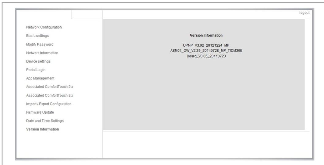
Informations sur la version propose des informations sur les composants matériels et logiciels de la Porte IP, et est nécessaire à des fins de réparation ou de diagnostic d'erreur.
