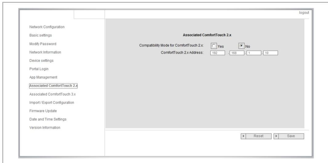
La Porte IP peut être utilisée pour contrôler le Busch-ComfortTouch® série 2.x. Le firmware du Busch-ComfortTouch® doit être à la version 2.4 ou une version ultérieure.
