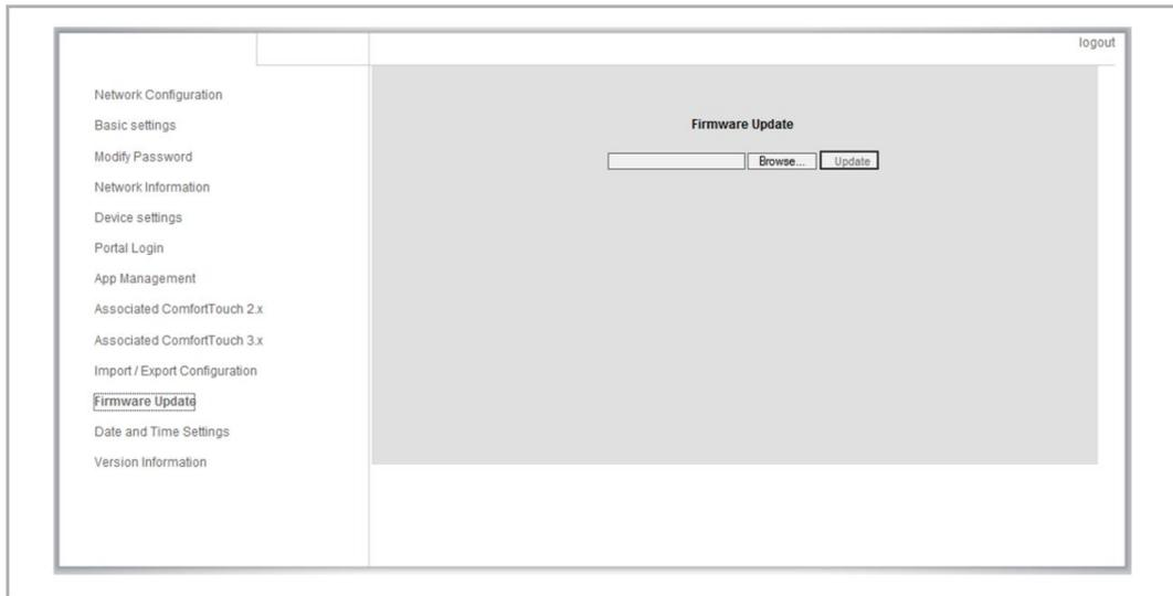
La IP-Puerta de Enlace permite actualizar el software del dispositivo de forma manual.
