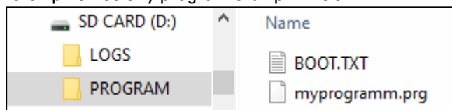
Rys. 71: Karta pamięci microSD z folderem PROGRAM zawiera plik BOOT.TXT i skompilowany program test.prg
