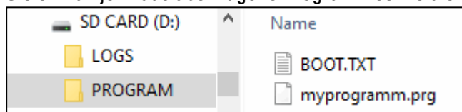
Abb. 71: Laufwerk microSD Speicherkarte mit Ordner PROGRAM enthält BOOT.TXT und kompiliertes Programm test.prg
