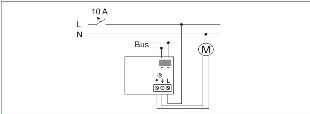
Abb. 5: Elektrischer Anschluss
