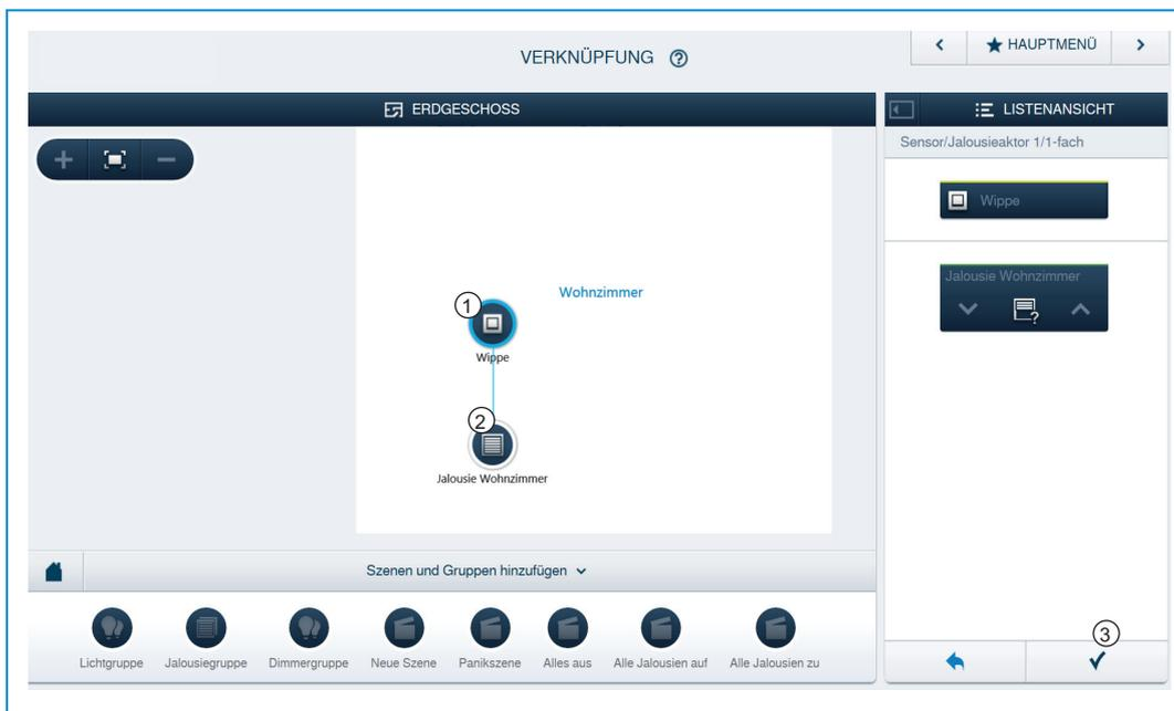
Abb. 13: Aktor und Sensor verbinden
