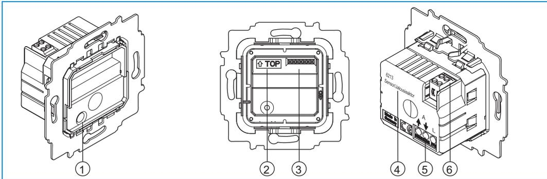
Abb. 2: Geräteübersicht Sensor/Jalousieaktor 1/1-fach und 2/1-fach (ohne Sensoren)
