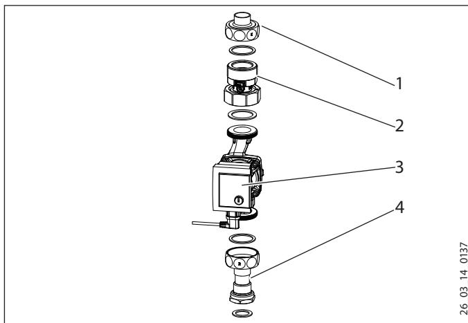
1 Écrou tournant avec insert
