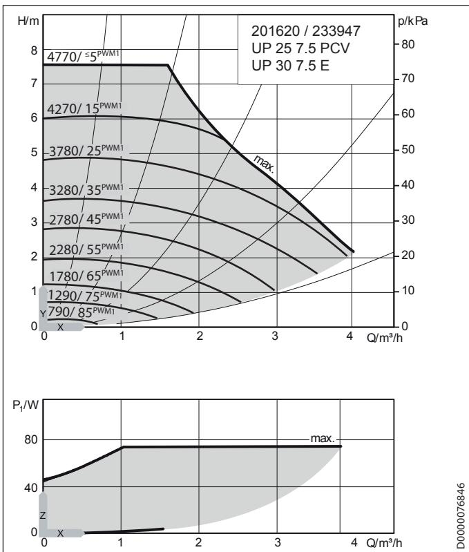
**UP 30/1-8E циркуляционные насосы рассола в контуре источника тепла**
