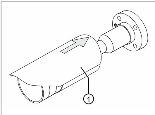
Abb. 10: Kameraabdeckung entfernen
