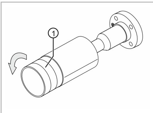
Abb. 11: Objektivabdeckung entfernen
