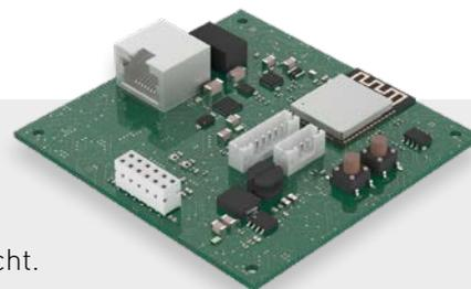
Das Duco Connectivity Board ist eine optionale Leiterplatte, die eine Verbindung zu Hausautomations- und Gebäudemanagementsystemen über REST API (lokal oder über die Cloud) oder über Modbus TCP (lokal) ermöglicht. Beides ist über Ethernet oder WLAN möglich.
