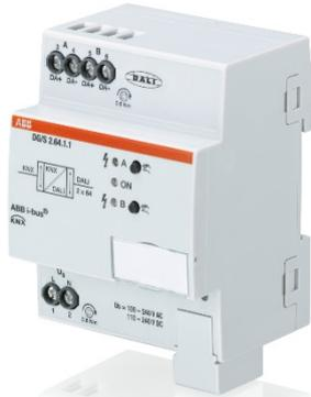
Los gateways DALI Básico DG/S x.64.1.1 ABB i-bus® KNX son aparatos KNX para montaje en rail DIN (MDRC) con diseño Pro M para instalación en el distribuidor en un rail de montaje DIN de 35 mm.
