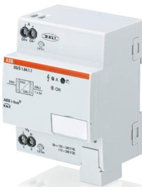
Die KNX ABB i-bus® DALI-Gateways Basic DG/S x.64.1.1 sind KNX-Reiheneinbaugeräte (REG) im Pro M-Design für den Einbau im Verteiler auf einer 35-mm-Tragschiene.
