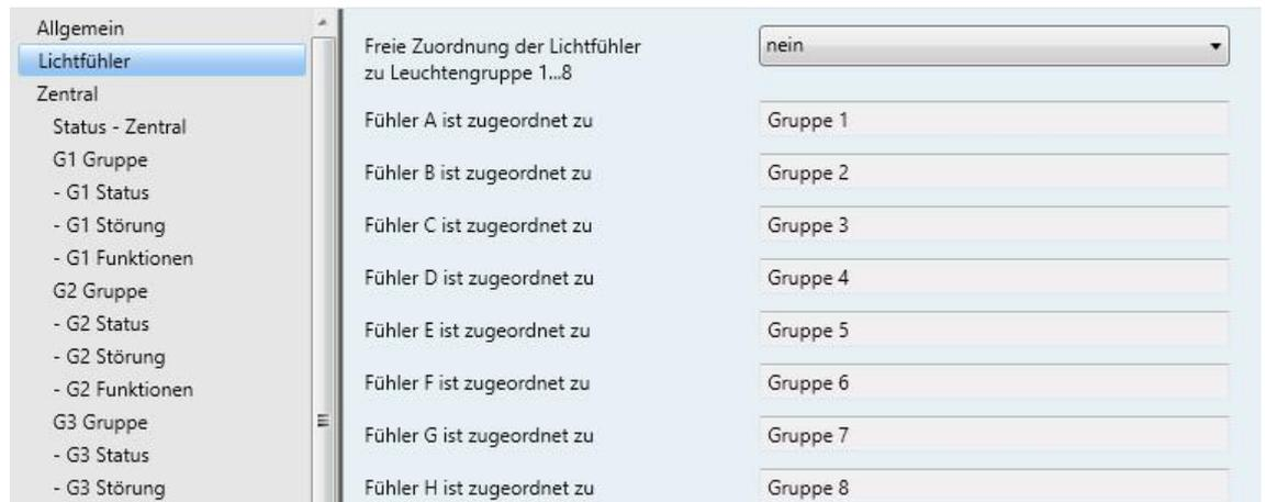
Werden mehrere Lichtfühler einem Ausgang zugeordnet, muss festgelegt werden, welcher Sensorwert als Istwert (Eingangsgröße) für den Regelkreis zu verwenden ist.
