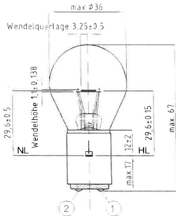
Neigung Socket Kolben max 3°
