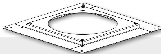
Avec ce cadre de transition, le remplacement d'une vieille tourelle de toiture devient un jeu d'enfant. Il n'est pas nécessaire d'ouvrir le roofing pour remplacer une tourelle de toiture dont l'entraxe est différent. Fixez cette plaque d'adaptation au-dessus du socle de toiture ou de l'amortisseur de bruit existant.
