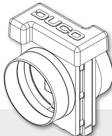
Le capteur d'humidité peut être intégré dans le réseau d'extraction (ETA) de la DucoBox Energy Comfort 325. Le caisson du capteur d'humidité a 2 raccords Ø160 (M). Le capteur est connecté à la carte électronique de la DucoBox Energy Comfort 325 par un câble d'alimentation et de communication fourni.
