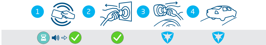
Figuur 4.4: Het laadproces starten met gebruikersautorisatie/RFID-laadpas. Symbolen die worden weergegeven op de gebruikersinterface
