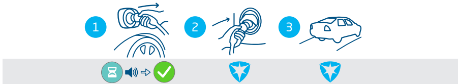
Figuur 4.6: Het laadproces stoppen zonder RFID-laadpas. Symbolen die worden weergegeven op de gebruikersinterface
