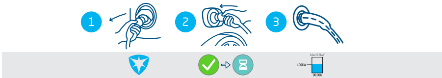
Figuur 4.5: Het laadproces starten zonder RFID-laadpas. Symbolen die worden weergegeven op de gebruikersinterface
