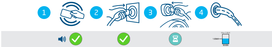
Figuur 4.3: Het laadproces starten met gebruikersautorisatie/RFID-laadpas. Symbolen die worden weergegeven op de gebruikersinterface
