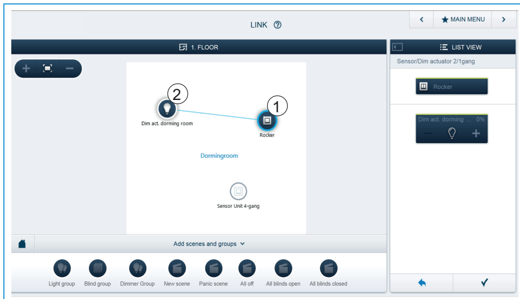
Afb. 13: Aktor en sensor verbinden
