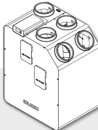
La DucoBox Energy Premium est un **appareil de ventilation équilibrée avec récupération de chaleur**. L'appareil garantit mécaniquement une pulsion d'air frais dans l'habitation et extrait mécaniquement l'air vicié de l'habitation à l'aide de ventilateurs intégrés. Au cours du processus, la chaleur est récupérée de l'air extrait et transférée à l'air d'arrivée.
