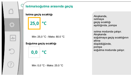
Fig. 51: Isıtma/soğutma_geçiş_sıcaklıkları arasında geçiş
