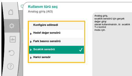
Fig. 84: Gerçek değeri sensörü ayar iletişim kutusu
