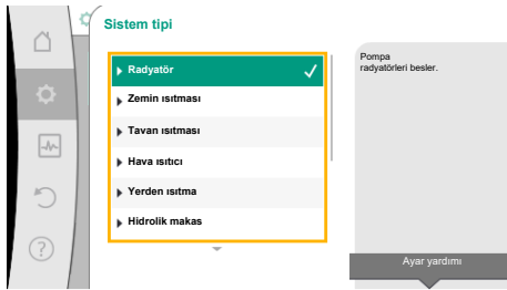
Fig. 41: Örnek "Radyatör" sistem tipi
