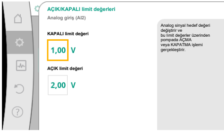
Fig. 80: Analog sinyaller üzerinden AÇIK/KAPALI kumandası ile ilgili limit değerleri
