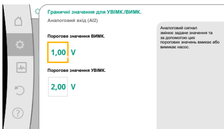
Fig. 80: Порогові значення для керування увімкненням/вимкненням через аналогові сигнали
