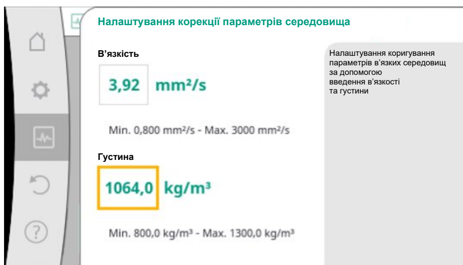
Fig. 97: Налаштування в'язкості та густини
