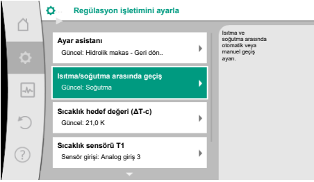
Fig. 47: Isıtma/soğutma arasında geçiş
