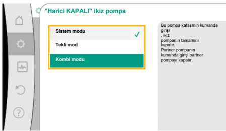
Fig. 65: İkiz pompalı EXT. OFF için seçilebilir modlar
