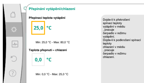
Fig. 51: Přepínání vytápění/chlazení_teploty přepnutí
